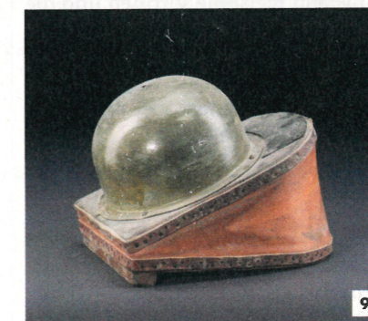
Abb. 7: Röntgenröhre, Urtyp, um 1900, Beiliegender Zettel: Urtyp einer Röntgenröhre wie sie W. C. Röntgen benutzte mit regenerierbarer Gasfüllung
